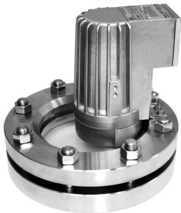
Tipo HEL 50 deHW, Ex de IIC T3, Ex tD A21 IP65 T195°C, Ex II 2 G + D, 230 V, 50 W, versione alogena, su oblò secondo DIN 28120, DN 125, PN 10. Montaggio in versione «vista ed illuminazione attraverso un oblò unico»
