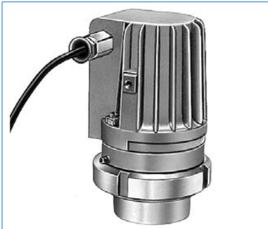
Tipo FKEL 20 dH R, Ex d IIC T4 Gb, Ex t IIIC T130°C Db IP67, Ex II 2 G + D, 230 V, 20 W, lampadina alogena, montato con cartella «R» su oblò avvitato similare a DIN 11851, DN 65, PN 6.
