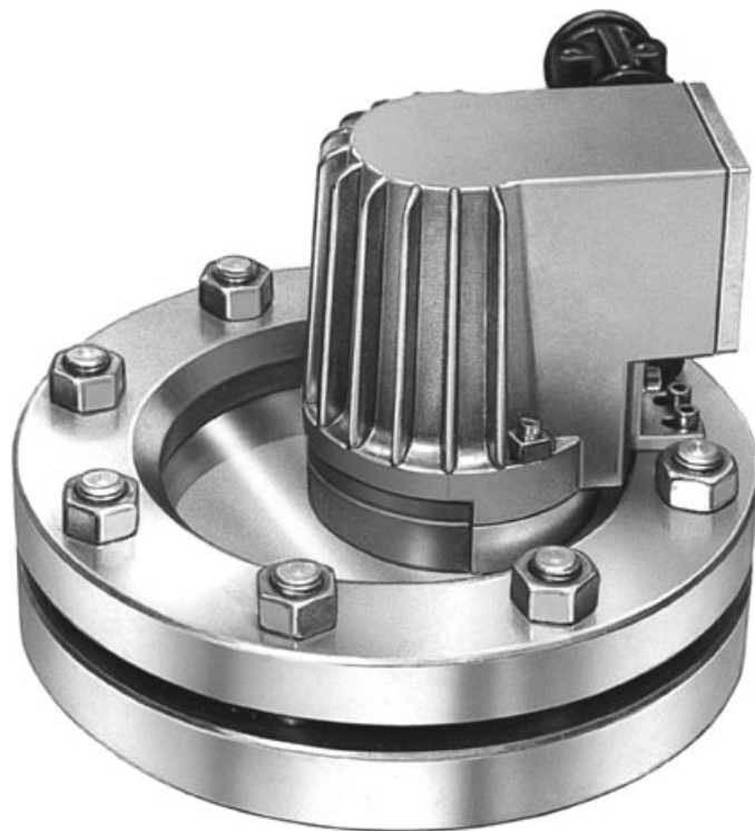
Proiettore tipo KEL 20 deH W, Ex de IIC T4, Ex tD A21 IP65 T130°C, Ex II 2 G + D, 230 V, 20 W, lampadina alogena, su oblò secondo DIN 28120, DN 125, PN 10. Montaggio in versione «vista ed illuminazione attraverso un oblò unico»
