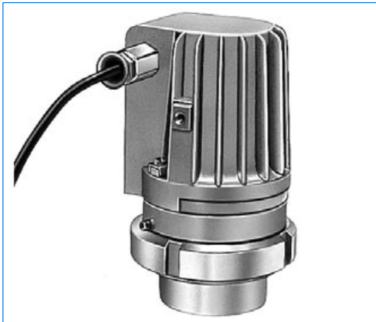
Tipo FKEL 20 dH R, Ex d IIC T4, Ex tD A21 IP65 T130°C, Ex II 2 G + D, 230 V, 20 W, lampadina alogena, montato con cartella «R» su oblò avvitato similare a DIN 11851, DN 65, PN 6.
