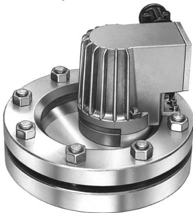
Proiettore tipo KEL 20 deH W, Ex d e IIC T4 Gb, Ex t IIIC T130°C Db IP67, Ex II 2 G + D, 230 V, 20 W, lampadina alogena, su oblò secondo DIN 28120, DN 125, PN 10. Montaggio in versione «vista ed illuminazione attraverso un oblò unico»
