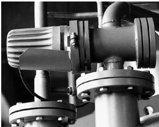
Proiettore CHEMLUX®, tipo L 20 deH M sp, 20 W, 24 V, Ex de IIC T5, Ex tD A21 IP65 T95°C, Ex II 2 G + D, con vetro opalizzato «M», montato su una spia visiva
