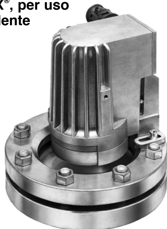
Proiettore tipo PEL 50 deHSch, Ex d e IIC T4 Gb, Ex t IIIC T130°C Db IP67, Ex II 2 G + D, 230 V, 50 W, lampadina alogena, su oblò secondo DIN 28120, DN 125, PN 10.
