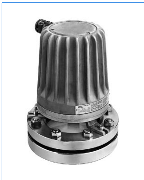
Proiettore alta efficienza tipo Typ 100 deHN, 100 W, 24 V, Ex de IIC T4, Ex tD A21 IP65 T130°C, Ex II 2 G + D, montata con trepiede «N» su oblò secondo DIN 28120, PN 10, DN 125
