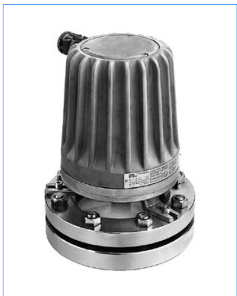
Proiettore alta efficienza tipo Typ 100 deHN, 100 W, 24 V, Ex d e IIC T4 Gb, Ex t IIIC T130°C Db IP67, Ex II 2 G + D, montata con trepiede «N» su oblò secondo DIN 28120, PN 10, DN 125
