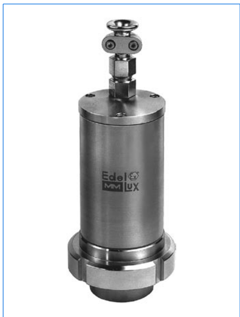
Proiettore tipo EdelEx 10 dH R50 K1, 10 W, 230 V, Ex d IIC T4, Ex tD A21 IP65 T130°C, Ex II 2 G + D, con cartella di fissaggio «R» su oblò avvitato similare a DIN 11851, PN 6, DN 50.
