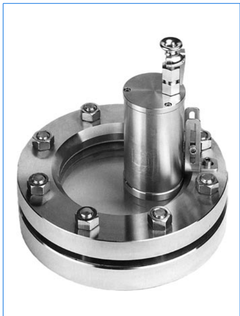
Proiettore tipo EdelEx 20 dH Sch K1, 20 W, 24 V, Ex d IIC T4, Ex tD A21 IP65 T130°C, Ex II 2 G + D, con staffa di fissaggio «Sch» su oblò rotondo secondo DIN 28120, PN 10, DN 125.
