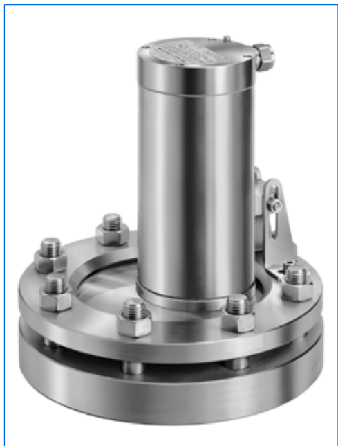
Proiettore tipo EdelEx 50 dH Sch K2, 50 W, 230 V, Ex d IIC T4, Ex tD A21 IP65 T130°C, Ex II 2 G + D, con staffa di fissaggio «Sch» su oblò rotondo secondo DIN 28120, PN 10, DN 150
