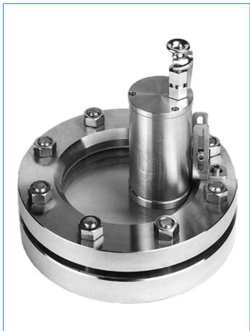
Proiettore tipo EdelEx d LED Sch K1, ca. 5 W, 100 - 240 V, Ex d IIC T6, Ex tD A21 IP65 T80°C, Ex II 2 G + D, con staffa di fissaggio «Sch» su oblò rotondo secondo DIN 28120, PN 10, DN 125.
