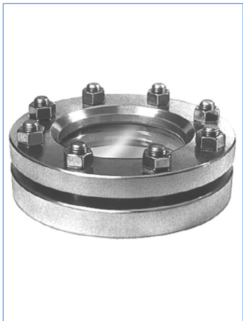
Oblò rotondo secondo DIN 28 120, DN 100, PN 10, vetro in borosilicato secondo DIN 7080
