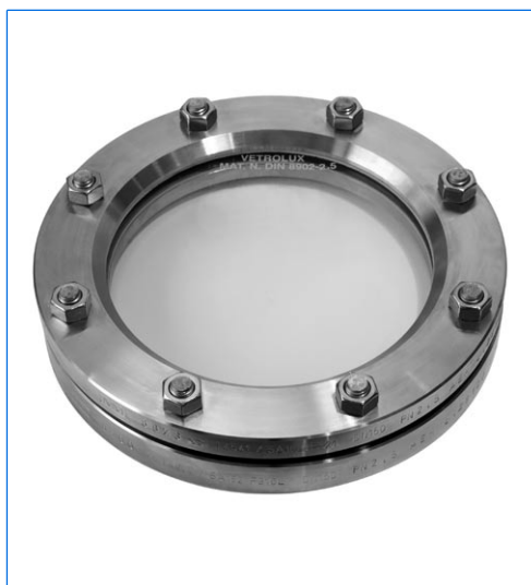
Oblò rotondo similare a DIN 28120, DN 150, PN 2,5, con vetro in calciosodico secondo DIN 8902
