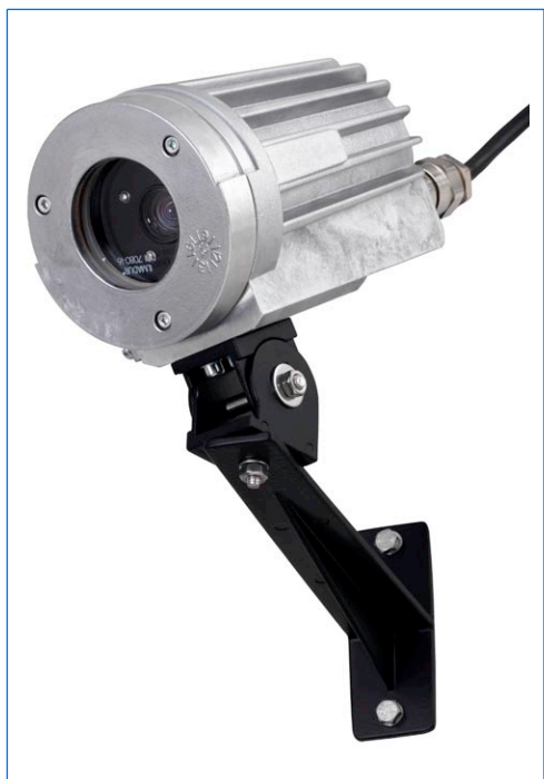
Videocamera AD-PE miniZoom, corpo in lega di alluminio, Ex d IIC T6, Ex tD A21 IP67 T80°C, Ex II 2 G + D, con fissaggio murale.
