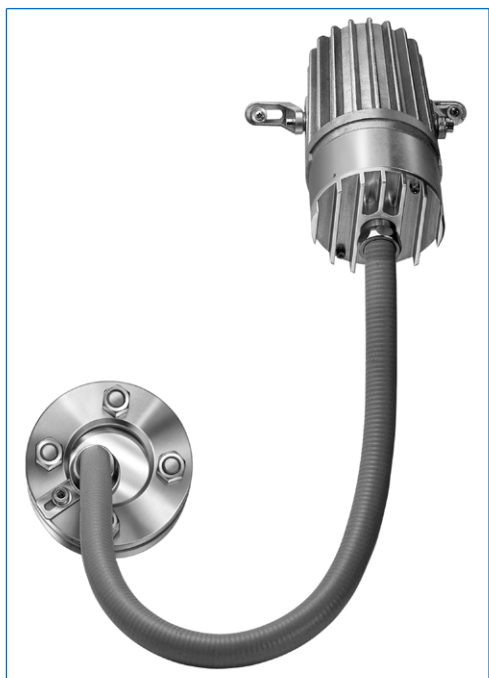
Proiettore AD-PE con fibra ottica e temporizzatore «V», tipo fibroLUX® 5035 X1 W2 V, Ex d e IIC T4 Gb, Ex t IIIC T130°C Db IP67, Ex II 2 G + D, 35 W, 230 V, fissaggio della sorgente luminosa con piedi «X1», fissaggio della fibra ottica con anello «W2» su oblò secondo DIN 28120, DN 40, PN 10
