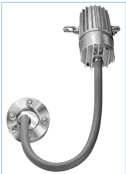
Proiettore AD-PE con fibra ottica e temporizzatore «V», tipo fibroLUX® 5035 X1 W2 V, Ex de IIC T4, Ex tD A21 IP65 T130°C, Ex II 2 G + D, 35 W, 230 V, fissaggio della sorgente luminosa con piedi «X1», fissaggio della fibra ottica con anello «W2» su oblò secondo DIN 28120, DN 40, PN 10
