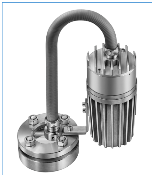
Proiettore AD-PE con fibra ottica e temporizzatore incorporato «U», tipo fibroLUX® 5035 W2 U sp, Ex de IIC T4, Ex tD A21 IP65 T130°C, Ex II 2 G + D, 35 W, 12 V DC, fissaggio della sorgente luminosa con squadra «W», fissaggio della fibra ottica con anello «W2» su oblò secondo DIN 28120, DN 40, PN 10
