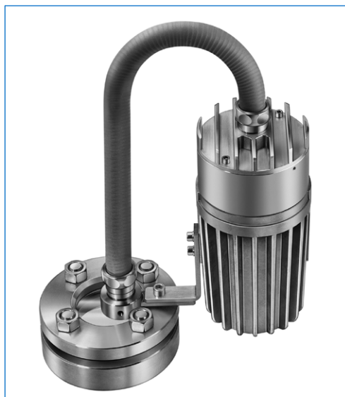
Proiettore AD-PE con fibra ottica e temporizzatore incorporato «U», tipo fibroLUX® 5035 W W2 U sp, Ex d e IIC T4 Gb, Ex t IIIC T130°C Db IP67, Ex II 2 G + D, 35 W, 24 V AC, fissaggio della sorgente luminosa con squadra «W», fissaggio della fibra ottica con anello «W2» su oblò secondo DIN 28120, DN 40, PN 10
