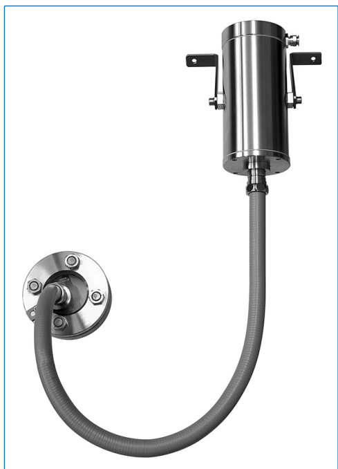
Proiettore AD-PE in acciaio inossidabile con fibra ottica, tipo fibroLUX® E 5035 X1 W2, Ex d IIC T4, Ex tD A21 IP65 T130°C, Ex II 2 G + D, 35 W, 230 V, fissaggio della sorgente luminosa con piedi «X1», fissaggio della fibra ottica con anello «W2» su oblò secondo DIN 28120, DN 40, PN 10
