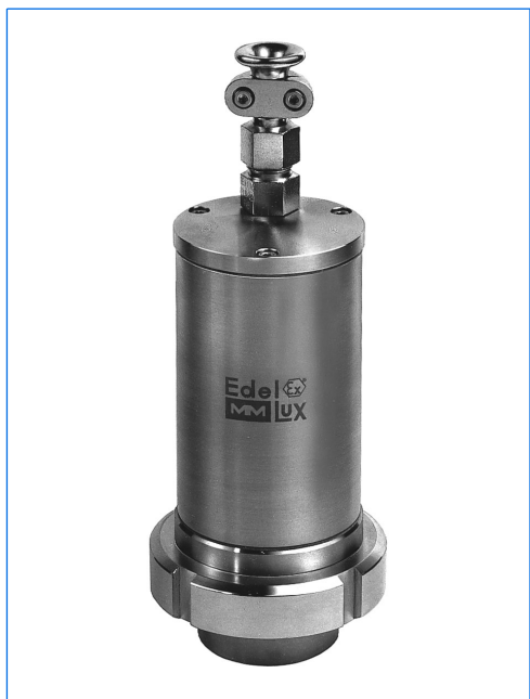
Proiettore tipo EdelEx d LED R50 K1, ca. 2 W, 24 V, Ex d IIC T6, Ex tD A21 IP65 T80°C, Ex II 2 G + D, con cartella di fissaggio «R» su oblò avvitato similare a DIN 11851, PN 6, DN 50.
