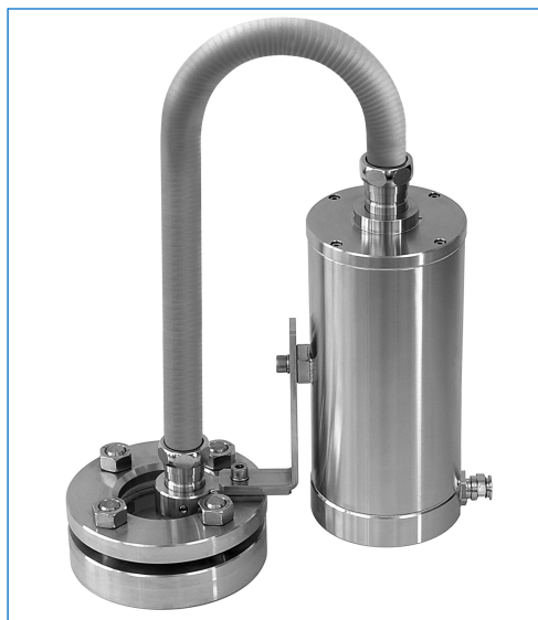
Proiettore AD-PE in acciaio inossidabile con fibra ottica, tipo fibroLUX® E 5035 W W2 sp, Ex d IIC T4, Ex tD A21 IP65 T130°C, Ex II 2 G + D, 35 W, 12 V DC, fissaggio della sorgente luminosa con squadra «W», fissaggio della fibra ottica con anello «W2» su oblò secondo DIN 28120, DN 40, PN 10
