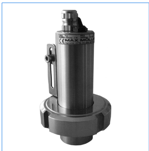
Micro-proiettore LED, tipo MVLR 2 LED, 2 W, 24 V AC/DC, con interruttore «marcia-arresto» «E» incorporato, montato su oblò avvitato VETROLUX similare a DIN 11851, DN 32, PN 6
