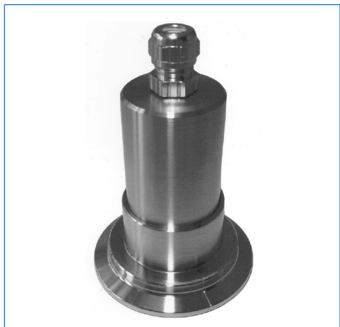
Micro-proiettore LED, tipo MVLR 2 LED, 2 W, 24 V AC/DC, montato su oblò con vetro sigillato per raccordi Triclamp®, DN 50, PN 16
