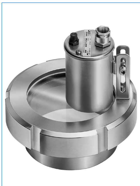
Proiettore tipo BKVLR 50 HDSch1, 50 W, 24 V, con pulsante incorporato «D», montato su oblò avvitato simile a DIN 11851, DN 100, PN 6, in versione «vista ed illuminazione attraverso un oblò unico».
